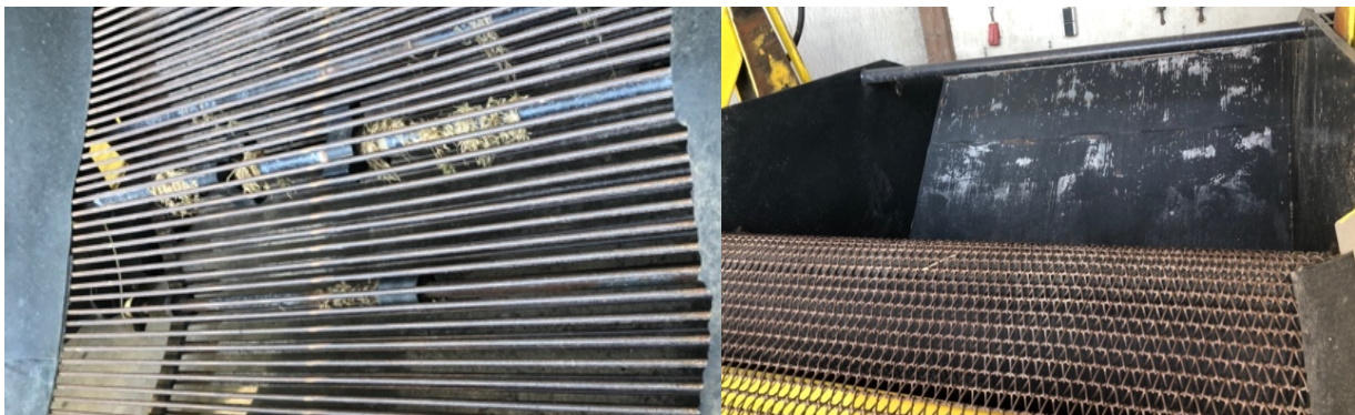
Figuur 3. Details van de beachcleaner. Links: een grove zeefmat met een tussenopening van 22 mm. Rechts: een fijne zeefmat.
